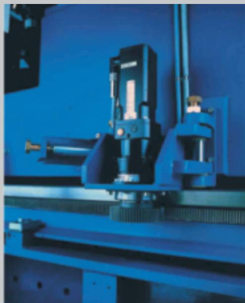
Cilindros de ar nos dois motores AC longitudinais para incrementar produtividade e acuidade.
