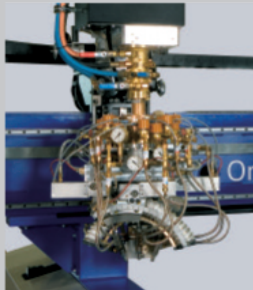
Corte de chanfros con giro infinito multi-maçaricos com suspensão de corte DAFL
