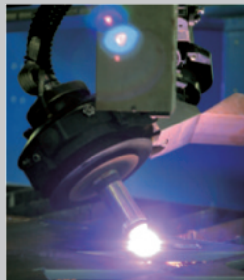
Corte de chanfros com plasma com suspensão Delta Skew Rotator, para corte de chanfros automaticamente Cabezal de corte de biselado por plasma Skew Axis Rotator para cortes de biselado de contorno automáticos
