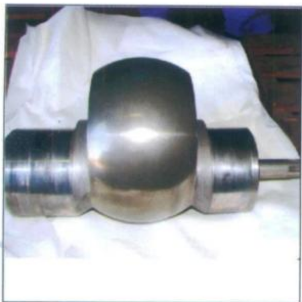
Revestimento/recuperação de eixos excêntricos.
