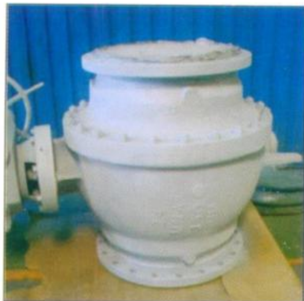
Revestimento anti-corrosivo em válvulas de grande porte e aplicação de selantes.
