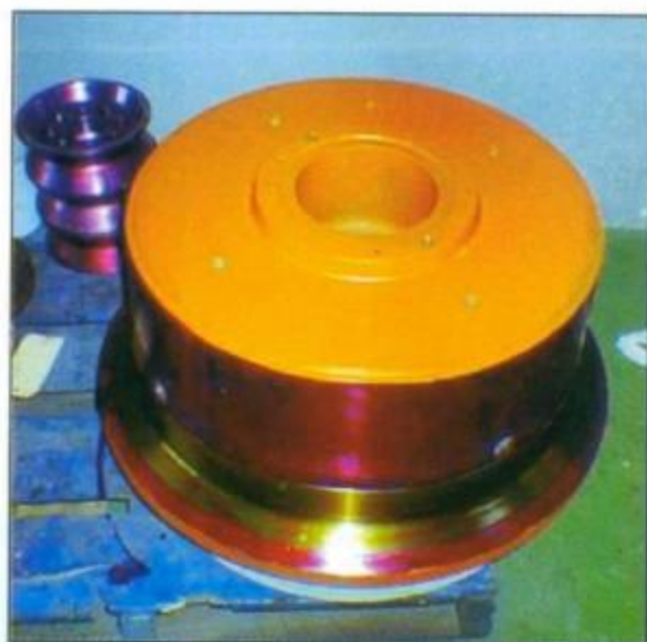
Revestimento/recuperação em bobina de trefila.
