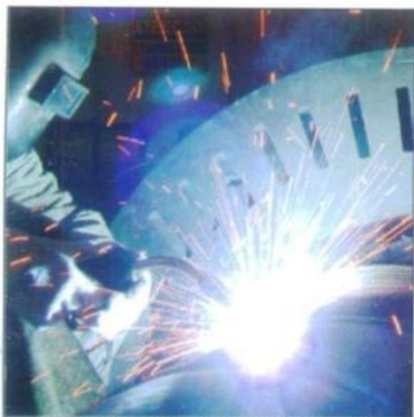
Revestimento/recuperação por soldagem com as mais variadas ligas como Monel, Inconel, Stellite e outros.
