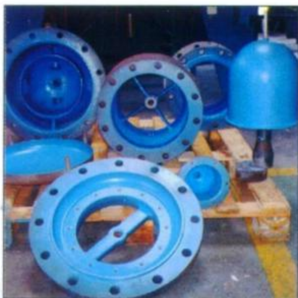
Revestimento polimérico em carcaça e periféricos de válvulas.
