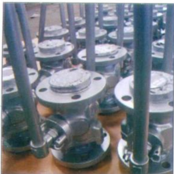
Revestimento anti-corrosivo em válvulas e pintura.
