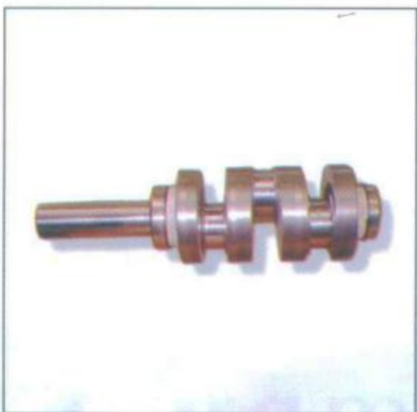
Revestimento/recuperação de colos de virabrequins.
