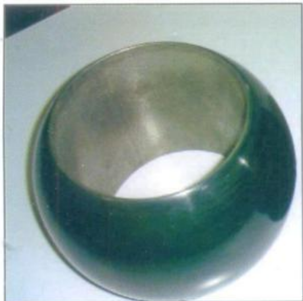
Revestimento/recuperação de válvulas esféricas.
