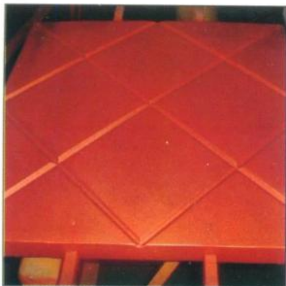
Revestimento anti-aderente em placas de moldes.
