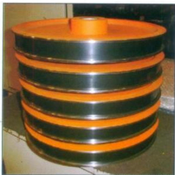
Revestimento/recuperação em roldanas.
