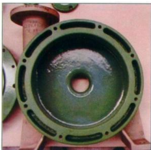
Revestimento anti-aderente em rotores e válvulas.
